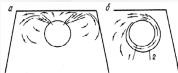
Рис. 2. Схемы использования взвихривающих воздухопроводов для ликвидации слоевых скоплений газа: а, б — выпуск сжатого воздуха в виде обычных и закрученных свободных струй соответственно; 1 — воздухопровод; 2 — спиральный кожух
