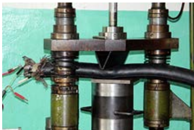
Рис. 2. Гидравлический пресс для раздавливания кабелей ПАО «НИКИ г. Томск»
