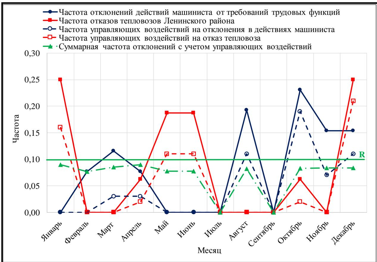
Рисунок 3 – Графики частот отклонений и компенсирующих управляющих воздействий в пределах допустимого уровня риска
